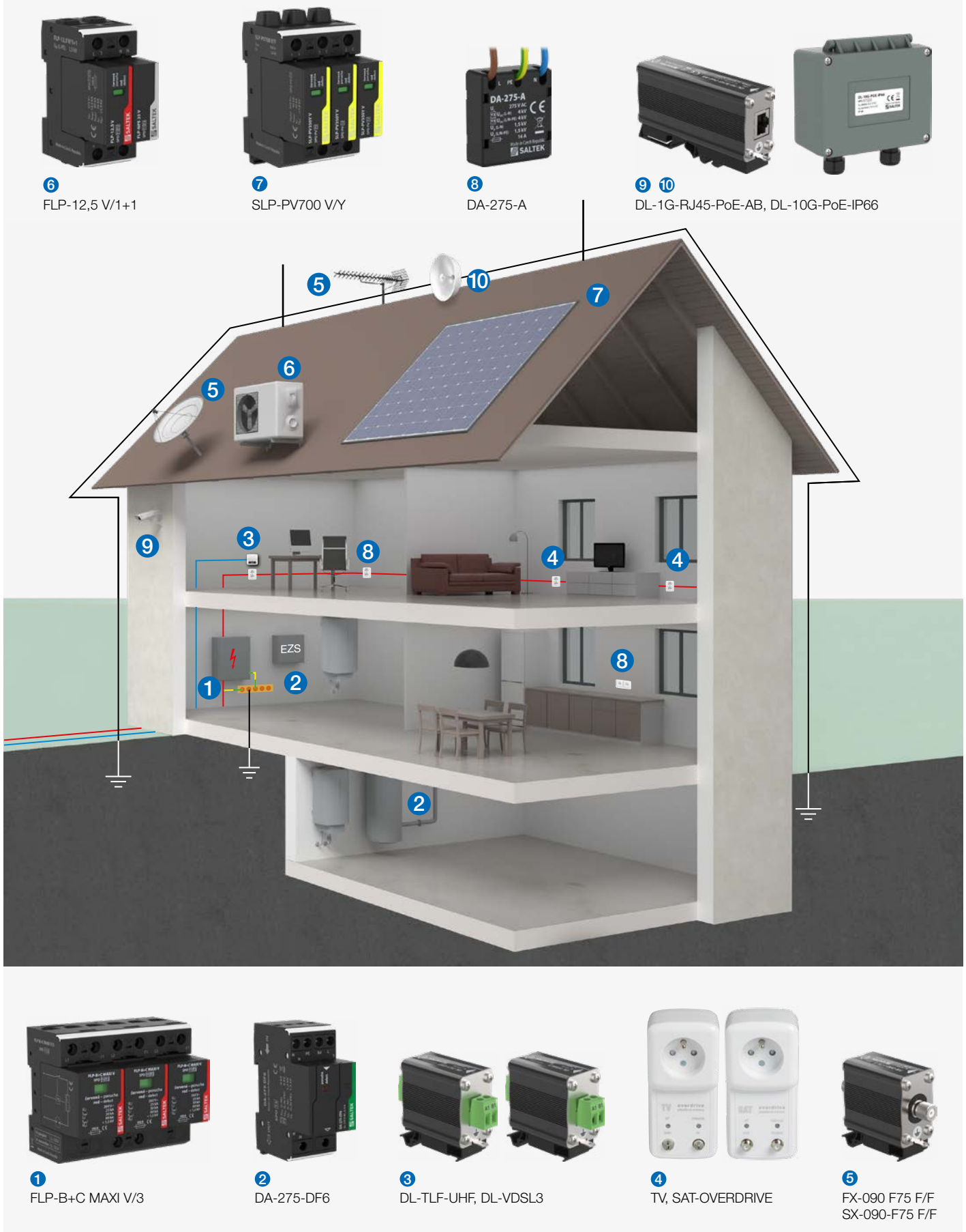
obr. 1 Příklad instalace přepětových ochran v rodinném domě
